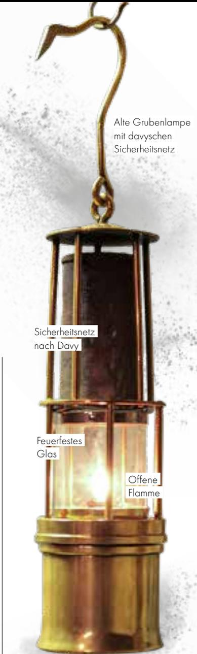
Michael Faraday, dass sich ein hochexplosives Methan-Luft-Gemisch in engen Röhren mit weniger als 3,5 mm Durchmesser nicht mehr entzündet. Ein Drahtnetz oder Sieb mit ausreichend feinen Maschen (Flammensieb) nutzt nun diesen Effekt aus. Dabei wird die Temperatur des brennenden Dampf-
