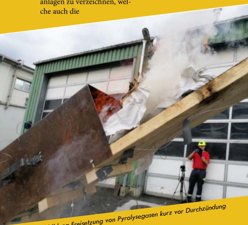
Abbildung Freisetzung von Pyrolysegasen kurz vor Durchzündung
