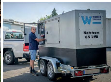
Das Zentralpumpwerk Bad Gleichenberg ist mit einem Notstromaggregat ausgerüstet – fünf bis sechs Tage kann der Wasserverband Vulkanland die Wasserversorgung im Blackout-Fall aufrechterhalten
