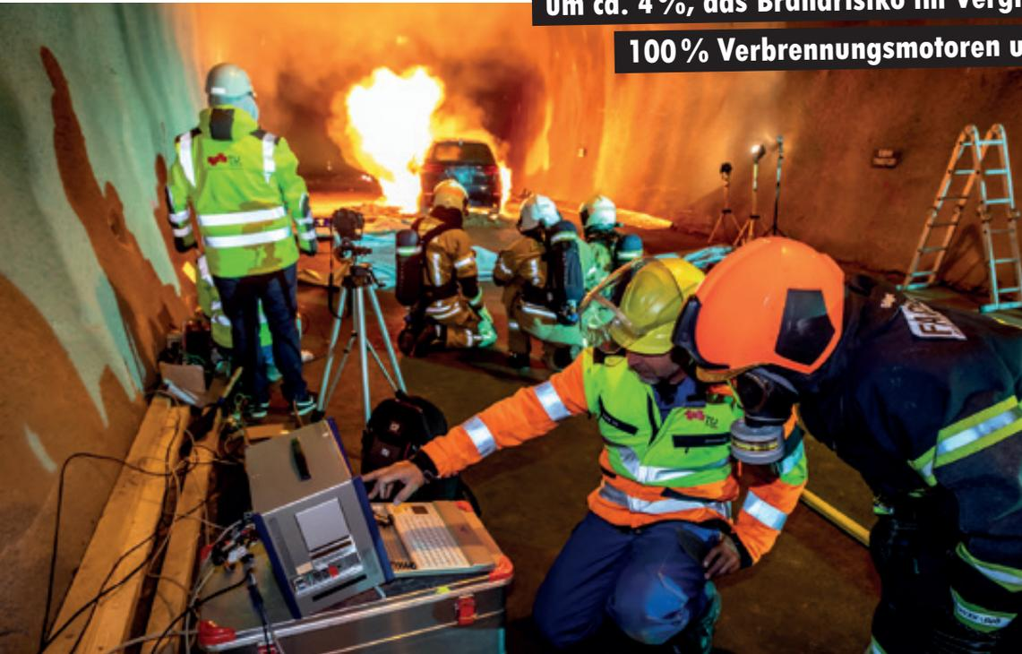
Im Zuge des Projekts konnte die Feuerwehr verschiedene Löschmethoden für brennende E-Fahrzeuge in Tunnelanlagen testen.
