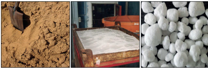
Sand: Quarzsand (CaCO 3 ) D-Pulver: Gemisch aus NaCl, KCl und MgCl 2 PyroBubbles (Körner 0,5 bis 5 mm aus SiO 2 )
