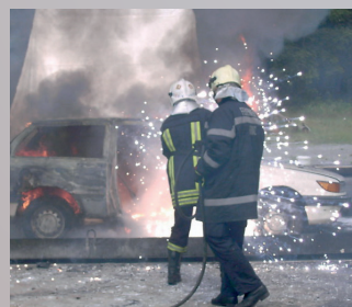
Auto-Versuchsbrand mit Magnesiumlegierungen. Foto: Oswald
