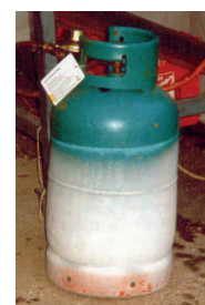
Vereiste Flüssiggasflasche nach zu schneller Entnahme von Propangas
