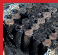
LiFePO4-Akkus blieben im Batteriepack und setzten sich bei intensiver Raumentwicklung thermisch um.
