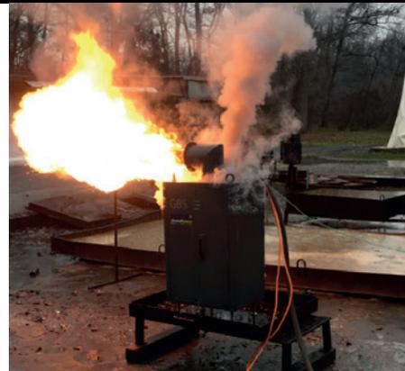
„Thermal Runaway“ an einem großen Batteriepack im Zuge eines Brandversuches an der Feuerwehr- und Zivilschutzschule Steiermark (Quelle: Widetschek [1]).
