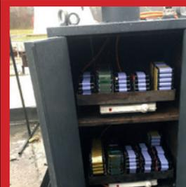
Mit Li-Ionen-Akkus beladener Sicherheitsschrank mit Wasseranschluss (siehe oben).
