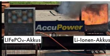
Lithium-Ionen-Akkus sind wesentlich instabiler als Lithium-Eisenphosphat-Akkus und brennen kettenreaktionsartig ab. Bei Lithium-Eisenphosphat-Akkus (links) kam es zu keiner Flammenwirkung aber zu Zerstörungen von Einzelbatterien.
