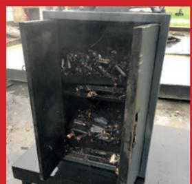
Alle Lithium-Ionen-Akkus wurden beim Brandversuch zerstört.
