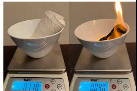
Beim Abbrand von Zellulose verringert sich das Gewicht in kurzer Zeit von 118 g auf 40 g
