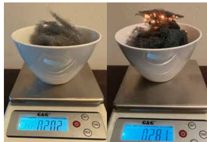
Innerhalb weniger Minuten werden aus 202 g Stahlwolle (Eisen) beim Verbrennen 281 g Eisenoxid.
