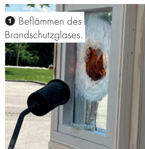
2 Die erste Floatglasscheibe bricht, das Gel schäumt auf!
