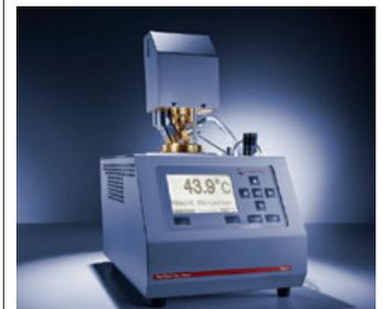
Gerät zur Bestimmung des Flammpunktes von brennbaren Flüssigkeiten nach Abel und Pensky-Martens
