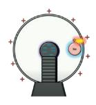
Erklärung: Zwischen der zentralen Elektrode und der Glaskugel ist ein elektrisches Feld vorhanden, welches die vorhandenen Elektronen beschleunigt. Dabei prallen sie auf diesem Weg auf Gasatome und schlagen laufend weitere Elektronen aus den Atomhüllen. Dieses Phänomen nennt man Stoßionisation, wobei auch Leuchteffekte in Form kleiner Blitze auftreten. Fass man nun die Kugel mit einem
