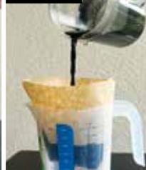
Mit diesem Experiment zeigen wir, wie Farb-, Geschmacks- und Geruchsstoffe aus einer Flüssigkeit gefiltert werden können. Dazu verwenden wir duftenden Rotwein, der sich mithilfe von Aktivkohle in geschmacklosen „Weißwein“ verwandelt.
