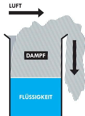
Dämpfe von Flüssigkeiten sind (mit einer Ausnahme; siehe Grafik Seite 33) alle schwerer als Luft und sinken nach unten.
