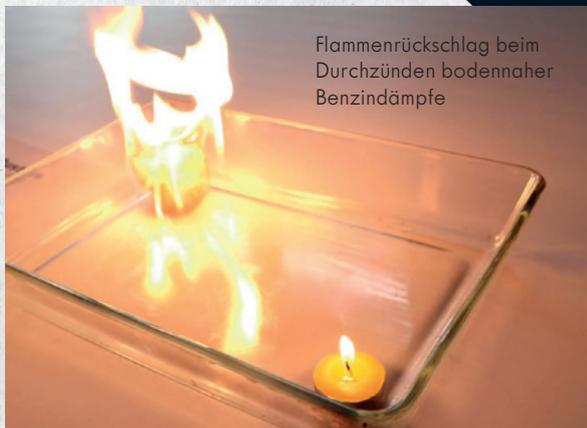
Mit diesem einfachen Experiment soll gezeigt werden, dass Dämpfe von brennbaren Flüssigkeiten schwerer als Luft sind und sich am Boden bzw. in Schächte, Kanäle und andere tiefer gelegene Bereiche ausbreiten können. Benzindampf ist dabei beispielsweise etwa vier Mal schwerer als Luft (Dichtezahl) und stellt beim Einsickern in Kanäle eine große Explosionsgefahr dar.
